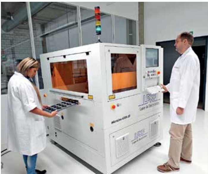
Новая установка Microline 6320 S компании LPKF с УФ-лазером для вскрытия окон во влагозащитном покрытии
